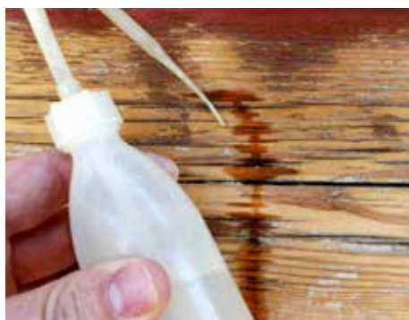
Benetzungsprobe, um zu prüfen, wie saugstark das Holz ist
